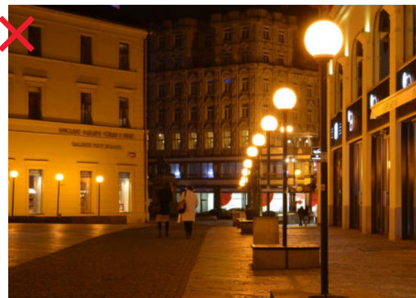
408 Rozmístění světelných míst, které nerespektuje půdorys veřejného prostoru, nepřirozeně dominuje prostoru a upoutává pozornost [ Praha 1, Jungmannova ]
