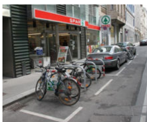
182 Parkování jízdních kol ve vozovce v rámci parkovacího pásu [ Rakousko, Vídeň ]
