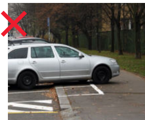
178 Nevhodná úprava šikmého stání formou dopravního značení na chodníku, kde parkující vozidla zužují průchozí profil [ Praha 9, Lovosická ]
