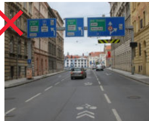
387 Nevhodné umístění návěstidla dálničního typu v městském prostředí přináší neadekvátní měřítko do struktury města [ Praha 5, Smíchov ]
