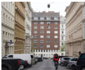
372 Osvětlení na převěsech mezi budovami uvolňuje prostor v ulici a umožňuje lepší zacílení osvětlení na střed ulice [ Rakousko, Vídeň ]
