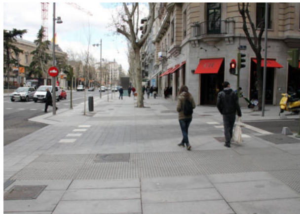
107 Velkoryse provedený chodník na významné ulici, který zachovává nadřazenost pěšího pohybu v místě napojení vedlejší ulice [ Španělsko, Madrid ]
