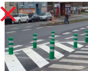
391 Dopravní vzhled balisetů, užívaných k dočasnému přerozdělení pohybu v prostoru neodpovídá charakteru městského prostředí. Tento prvek je tvaroslovím, materiálem a zejména barevností nevhodný pro použití ve městě a je třeba hledat jeho náhradu [ Praha 4, Jeremenkova ]
