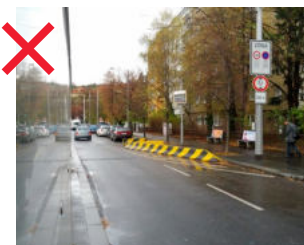
394 Citybloky – nevhodné fyzické zábrany průjezdu či parkování vozidel nebo pro ochranu chodců na přechodech. Ve městě se často vyskytují jako trvalé řešení. Dopravní vzhled neodpovídá městskému prostředí, měl by být revidován [ Praha 4, Podolí ]
