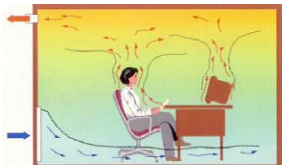
Obr. 2 Bezprůvanové „displacement“ větrání
