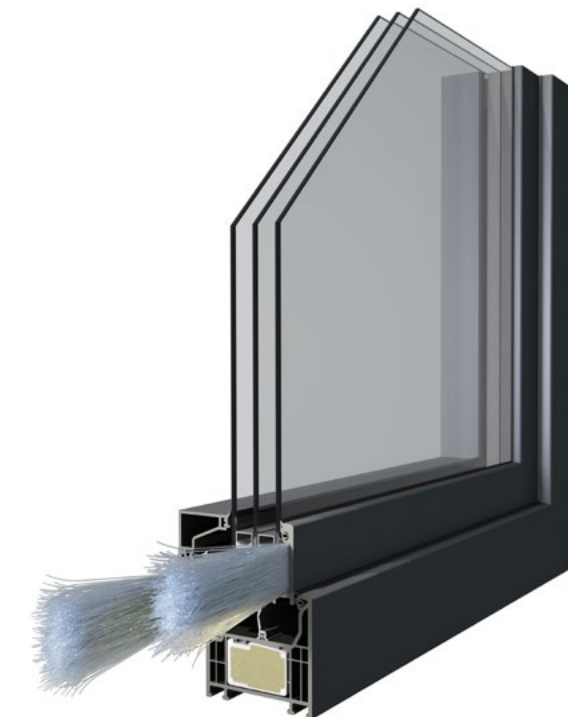
Skelná vlákna ThermoFibra jsou velmi pevná a jejich použitím v křídle je zároveň dosaženo nejlepších hodnot tepelné prostupnosti. V kombinaci s tepelnou výtuhou Forthex nahrazující ocel v rámu dosahuje Uf pouhých 0,85 W/(m 2 K). Foto: Deceuninck
